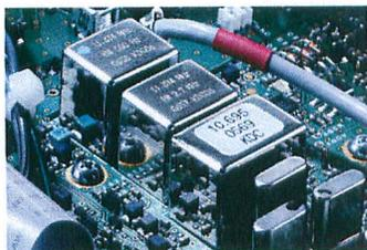
\*Durante la ricezione di segnali CW/FSK/SSB nelle gamme radio amatoriali dei 1.8/3.5/7/14/21MHz, con filtro passa banda a 2,7KHz o inferiore, viene automaticamente selezionata la conversione a bassa frequenza.
